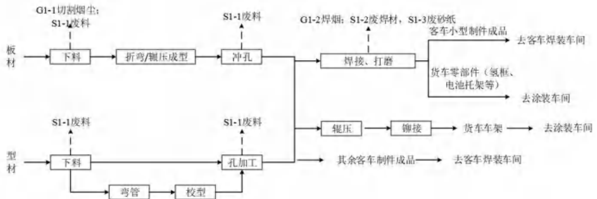
图 3.5-2 制件车间工艺流程及产污节点图
