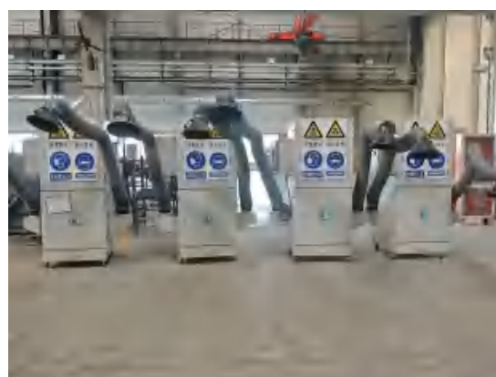
4 台移动式双臂焊烟净化器
