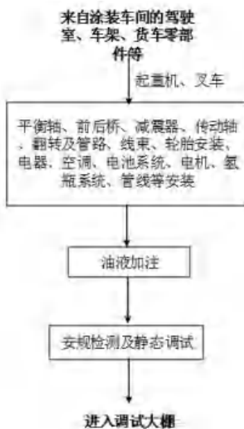
图 3.5-11 货车总装线工艺流程及产污环节图
